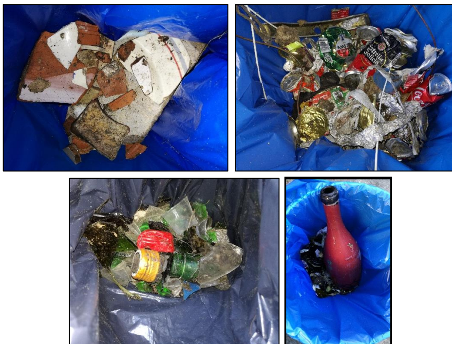
Figura 1: FNCR de rechazo grueso (de izq. a dcha. y de arriba a abajo): Inertes, metales, trozos de vidrio, botella de vidrio
