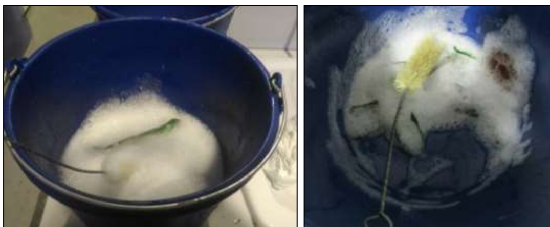
Figura 10: Remojado con agua con desengrasante (izq.) y limpieza con cepillo (dcha.) de la FNCR
