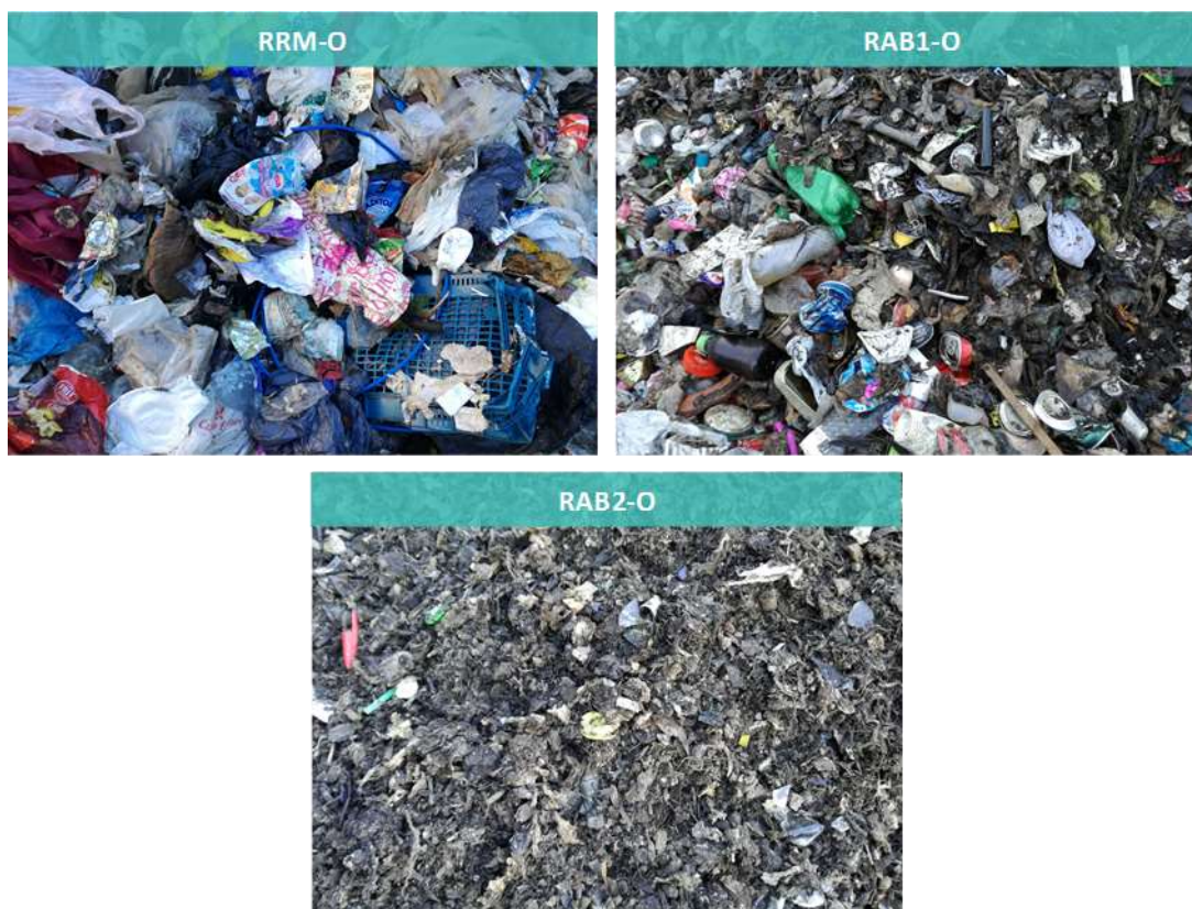
Figura 6.2 Rechazos generados en la planta de recuperación y compostaje de Onda
